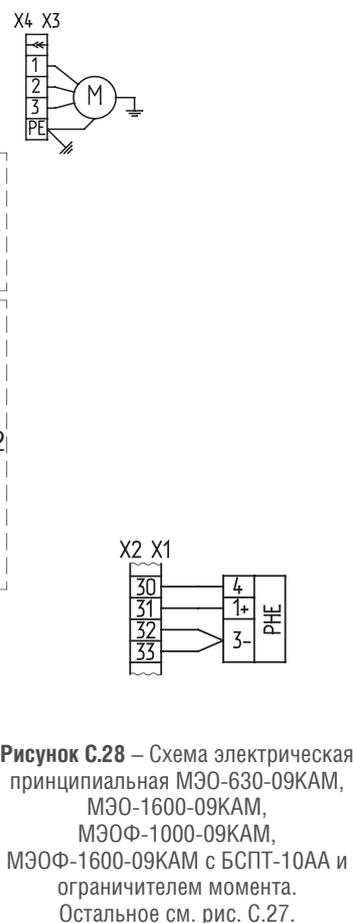
**Рисунок С.28** – Схема электрическая принципиальная МЭО-630-09КАМ, МЭО-1600-09КАМ, МЭОФ-1000-09КАМ, МЭОФ-1600-09КАМ с БСПТ-10АА и ограничителем момента. Остальное см. рис. С.27.
