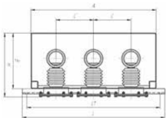
Токопроводы серии ТЗП на 10; 20 кВ.
