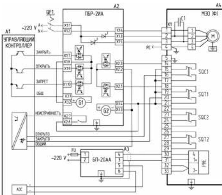
Схема управления трёхфазными механизмами МЭО(Ф)-КА с БСПТ-10АА с использованием бесконтактных пускателей ПБР-3АА
