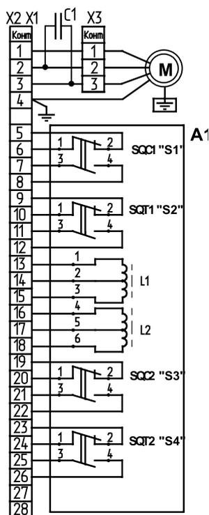
**Рисунок С.6** – Схема электрическая принципиальная МЭО-40-01А, МЭО-40-93А с БПИ.
