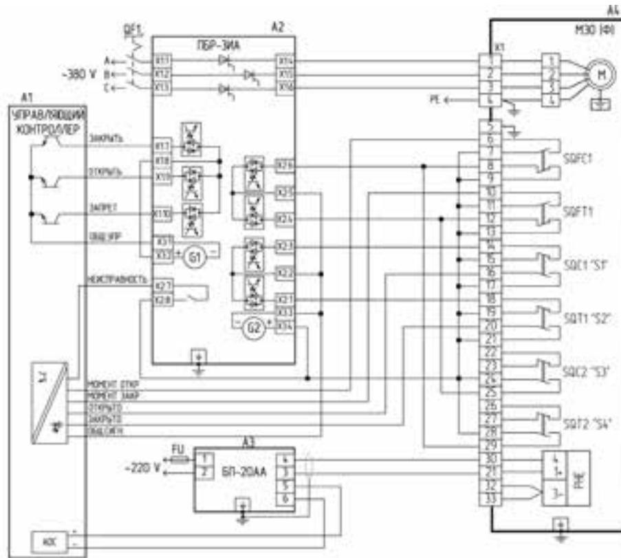
Схема управления однофазными механизмами МЭО(Ф)-А с БСПТ-10АА с использованием бесконтактных пускателей ПБР-2ИА
