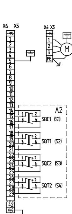
**Рисунок С.33** – Схема электрическая принципиальная МЗОФ-4000-99КА с разъемом HARTING.
