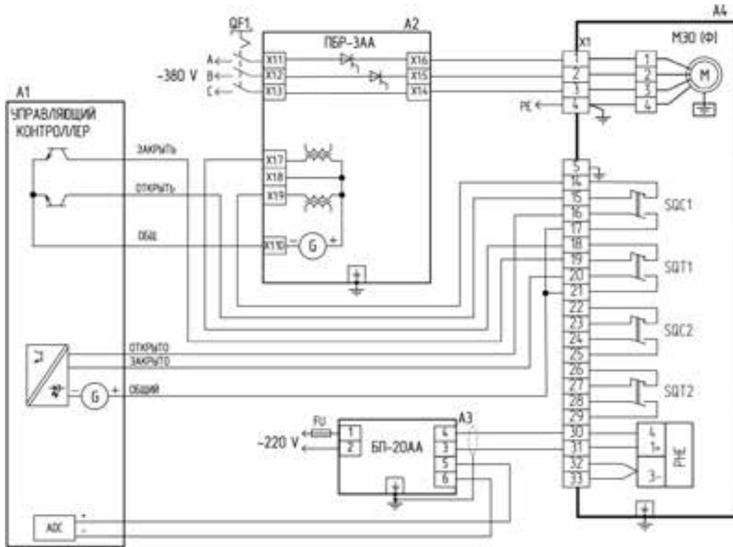
Схема управления однофазными механизмами МЭО(Ф)-А с БСПТ-10АА с использованием бесконтактных пускателей ПБР-2МА
