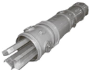
В шинопроводе ШЗК-1,2 две швеллерообразные шины соответствующего сечения располагаются внутри оболочки. В шинопроводе ШЗК-0,4 три швеллерообразные шины соответствующего сечения располагаются внутри оболочки по вершинам равностороннего треугольника. Шины крепятся к опорным изоляторам внутри оболочек специальными шинодержателями. Опорные изоляторы закрепляются к крышкам, которые крепятся на оболочках болтами через резиновые уплотнительные прокладки.
