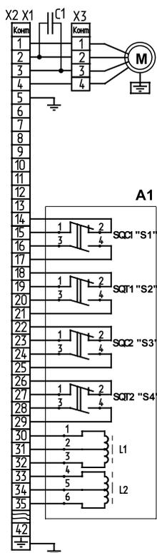
**Рисунок С.5** – Схема электрическая принципиальная МЭО(Ф)-40-08А с БПИ.
