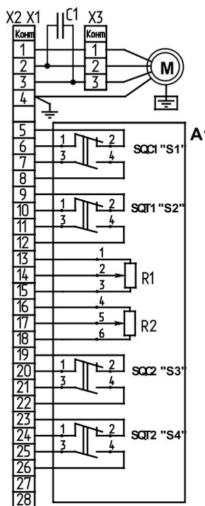
**Рисунок С.7** – Схема электрическая принципиальная МЭО-40-01А, МЭО-40-93А с БСПР.
