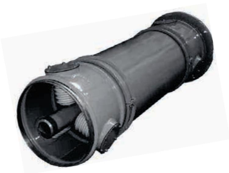
**Токопроводы напряжением 6, 10, 20, 24, 27, 35 кВ пофазно-экранированные комплектные** с компенсированным внешним электромагнитным полем на номинальные токи от 1600 до 33000 А предназначены для электрических соединений на электрических станциях, в цепях трехфазного переменного тока частотой 50 Гц, турбогенераторов мощностью до 1500 МВт с силовыми повышающими трансформаторами, с трансформаторами собственных нужд, с преобразовательными трансформаторами и трансформаторами тиристорного
