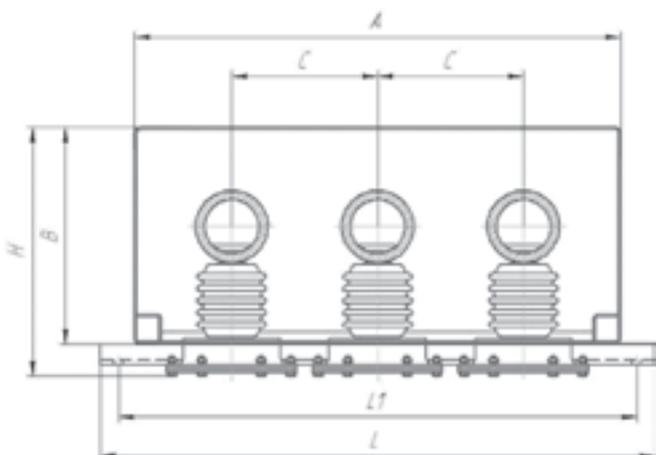
»» Рис. 8. Токопровод ТЗП напряжением 10, 20 кВ
