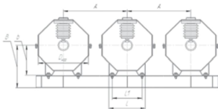
»» **Рис. 6.** Токопровод ТЗМЭП напряжением 6; 10 кВ
