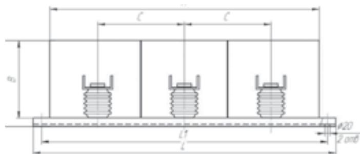
»» Рис. 11. Токопровод ТЗПР напряжением 10 кВ
