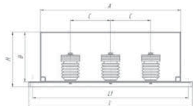
»» Рис. 14. Токопровод ТЗП напряжением 10 кВ
