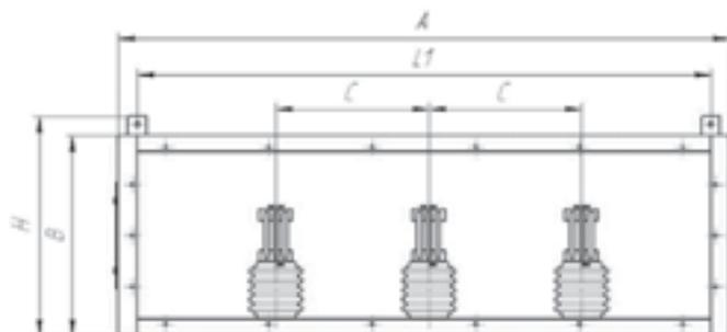
»» Рис. 13. Токопровод ТЗП напряжением 10 кВ
