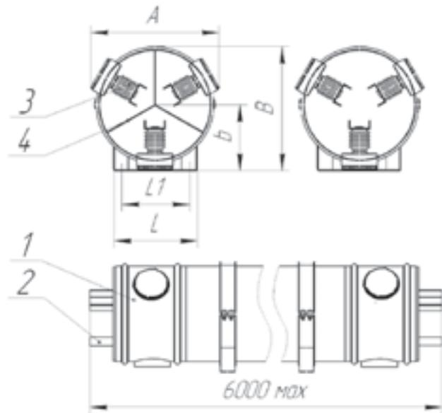
»» **Рис. 3.** Токопровод ТЗК; токопровод ТЗКР напряжением 0,4 (1); 3; 6; 10 и 15 кВ на токи 1600, 2000 А.
