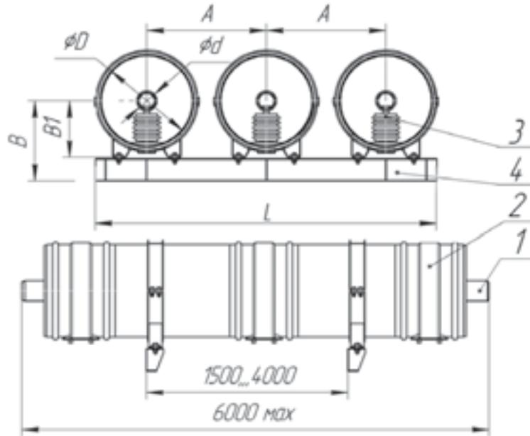
» **Рис. 1** Токопроводы ТЭНЕ напряжением 6, 10, 20 кВ. Секция прямолинейная
