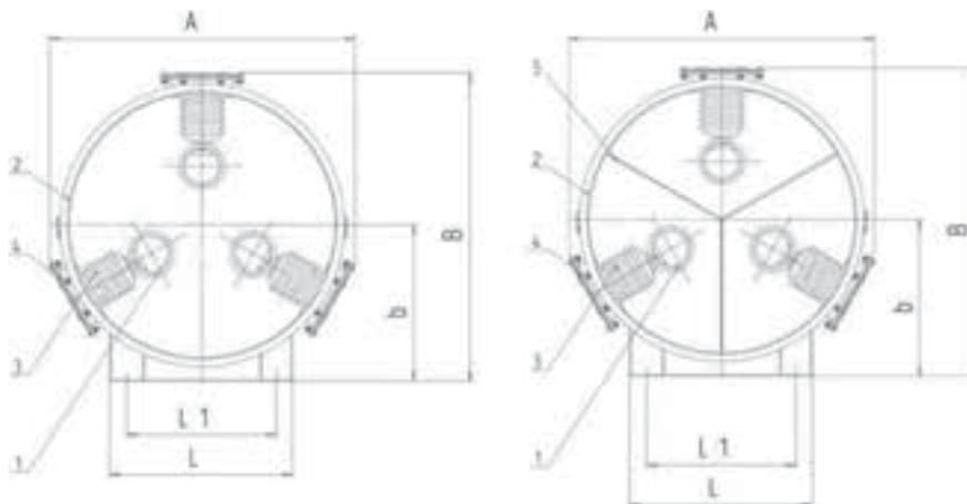
»» **Рис. 4.** Токопроводы ТЗК, ТЗКР напряжением 0,4 (1); 3; 6; 10 и 15 и 20 кВ на токи 2000, 2500, 3150, 4000 А
