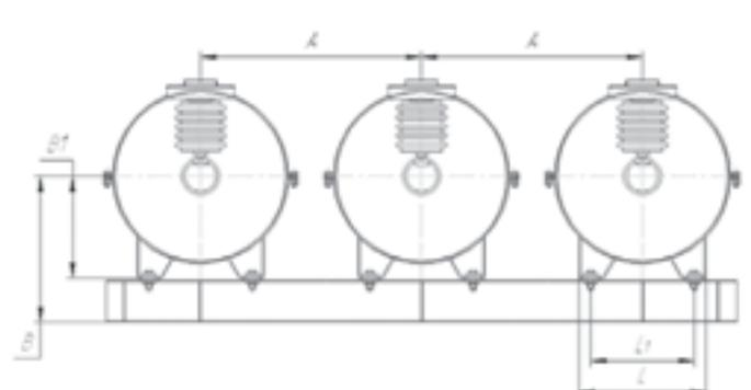
»» **Рис. 7.** Токопровод ТЗКЭП напряжением 6; 10 кВ
