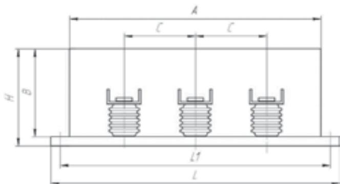
»» Рис. 10. Токопровод ТЗП напряжением 10 кВ
