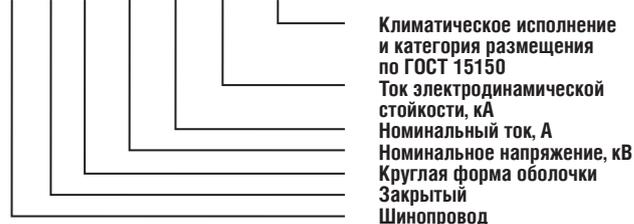
**Шинопроводы закрытые ШЗК** постоянного тока напряжением до 1,2 кВ на номинальные токи 2000, 4000, 5000 А предназначены для выполнения электрического соединения возбuditелей с панелями щитов рабочего и резервного возбуждения генераторов мощностью до 1200 МВт на электрических станциях.
