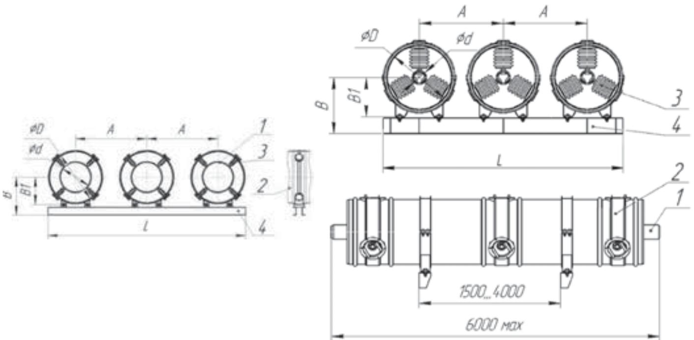
» **Рис. 2** Токопроводы ТЭНЕ напряжением 6, 10, 20, 24, 27, 35 кВ. Секция прямолинейная
