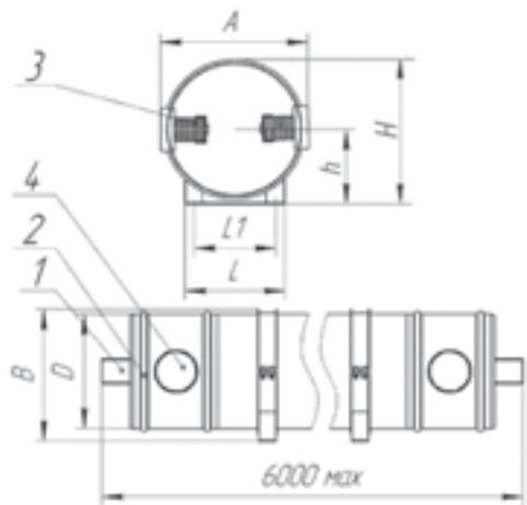
»» Рис. 15. Шинопровод ШЗК-1,2. Секция прямолинейная
