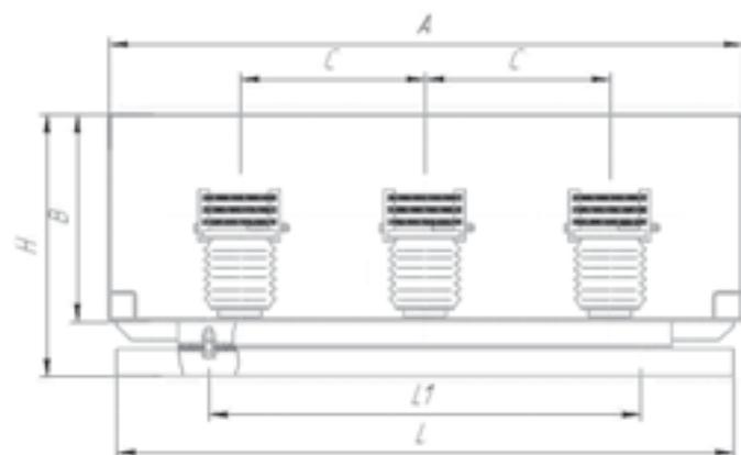
»» Рис. 12. Токопровод ТЗП напряжением 10 кВ
