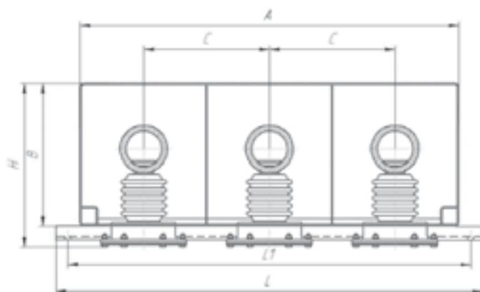
»» Рис. 9. Токопровод ТЗПР напряжением 10 кВ
