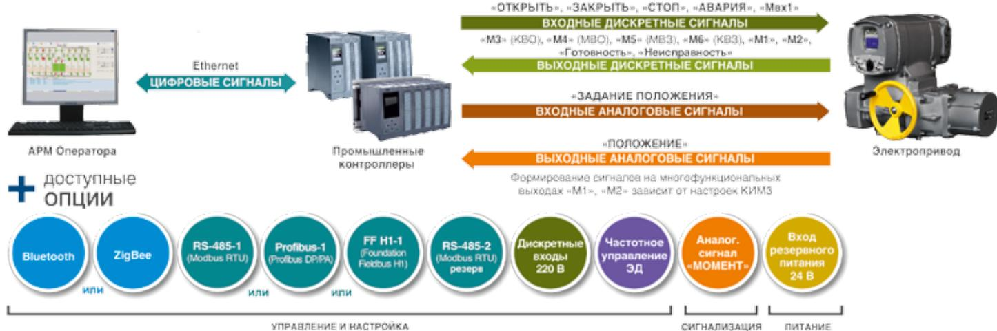
«Mvx1» – многофункциональный вход, «КВО» и «КВЗ» – концевые выключатели открытия и закрытия, «МВО» и «МВЗ» – моментные выключатели открытия и закрытия, «M1» и «M2» – многофункциональные выходы.
