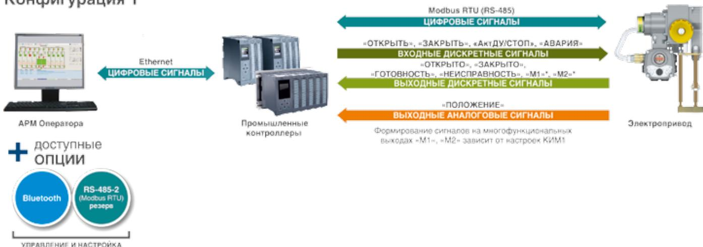
Подключение ЭП модификаций до 08-12 может быть **быстроръемным** (только для общепромышленных исполнений) или **клеммным** и происходит через блок управления. Настройка электропривода при основном питании осуществляется программно на трубопроводной арматуре без вскрытия оболочки, параметры сохраняются в энергонезависимой памяти.
